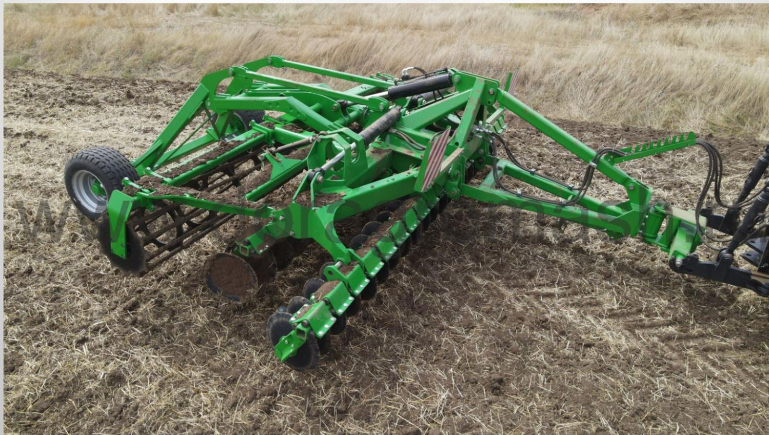
Компактная дисковая борона «Прометей» предназначена для рыхления и подготовки почвы под посев, для уничтожения сорняков и измельчения пожнивных остатков, разделки пластов почвы, предпосевной подготовки почвы без предварительной вспашки и обработки после уборки толстостебельных культур, с одновременным прикатыванием обработанной почвы.
